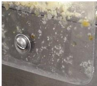
Imagen 9. Protector de salpicaduras que requiere una herramienta para ser desmontado, lo que crea un punto de captura
