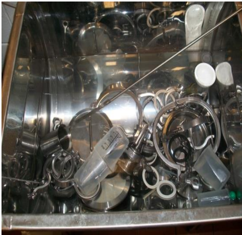
Imagen 18. Almacenamiento incorrecto de las partes en un tanque de COP. Deben almacenarse en áreas designadas
